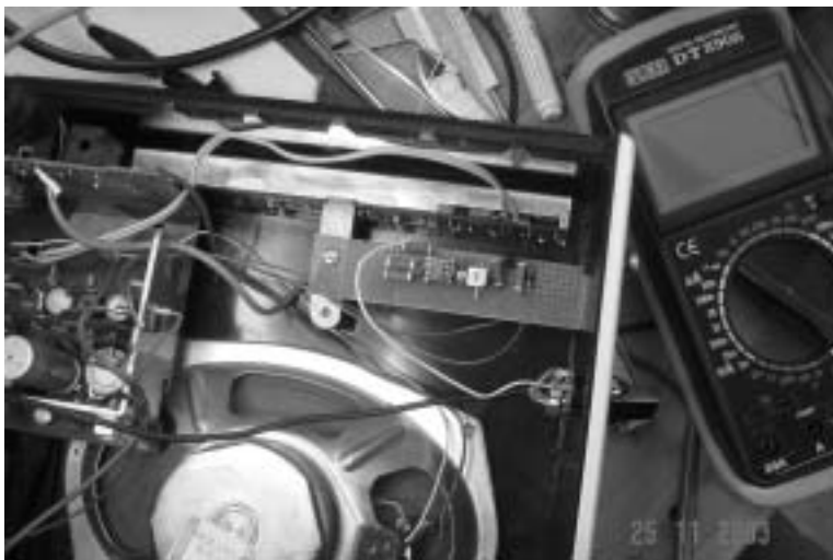
Figuur 6. De mixer ingebouwd in de radio
