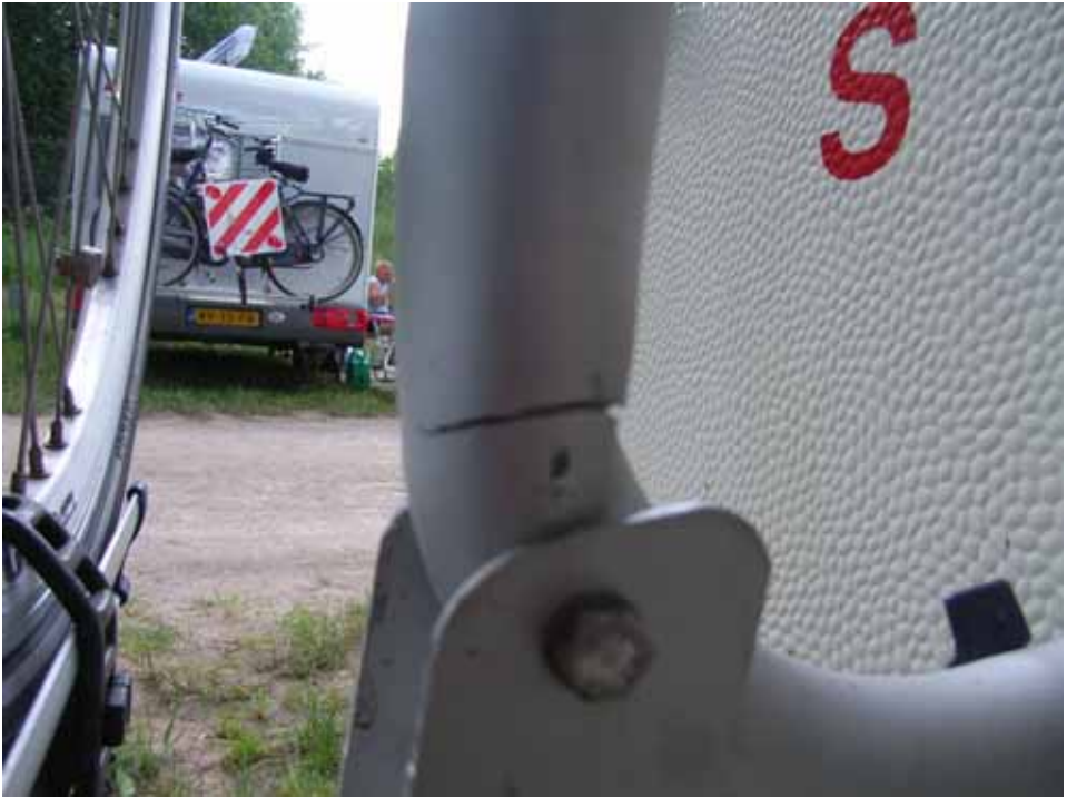
De gebroken draagbuis van de fietsendrager
