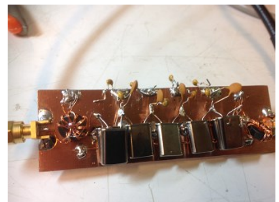
Het inmiddels met condensatoren behangen filter
