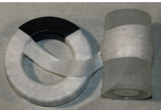
Met behulp van dit "gereedschap" bewikkelt DK7ZB de kernen met PTFE-band
