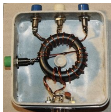
De trafo met 1:16, 1:25, 1:36, 1:49 en 1:64 omzetting
