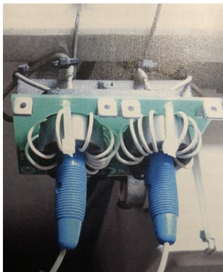
Zo meet DF2BC de antennestroom. Aflezen doet hij bij de transceiver
