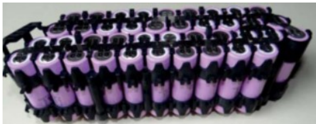
Zo ziet een E-bike-accu er vanbinnen uit
